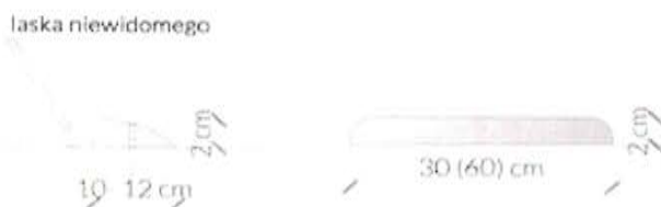
Rys. D3 – Profil rozdzielający ruch rowerowy od pieszego. Sygnalizujący koniec ciągu pieszego
